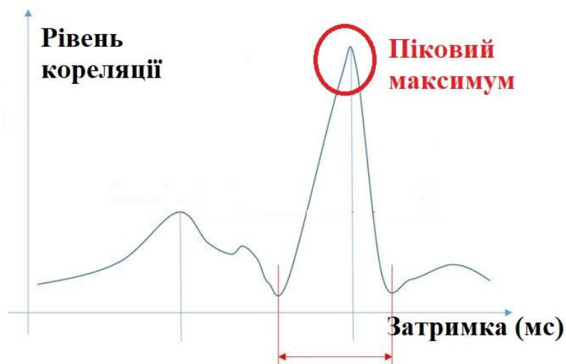
Рисунок 2 – Кореляційна функція сигналів S_1 та S_2
