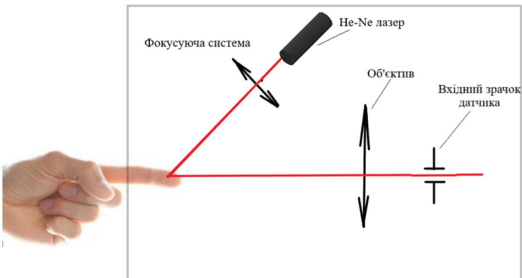
Рис. 2 – оптична схема вимірювання біоспеклів шкіри
