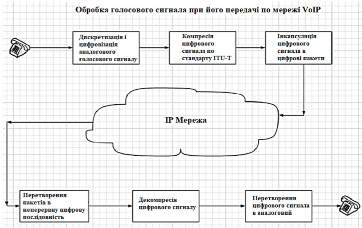
Рисунок 1. Обробка голосового сигналу при його передачі в мережі VoIP
