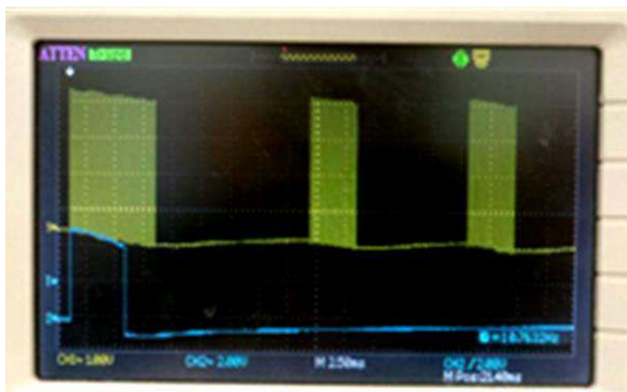
Рисунок 2. Осциллограма, що ілюструє роботу ультразвукового далекоміра
