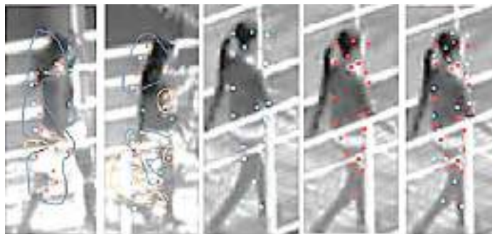
Рис. 1 – Приклад роботи алгоритму Kanade-Lucas Tomashi (KLT)
