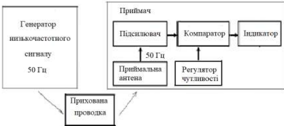
Рис. 1 – Структурна схема дистанційного індикатора напруги
