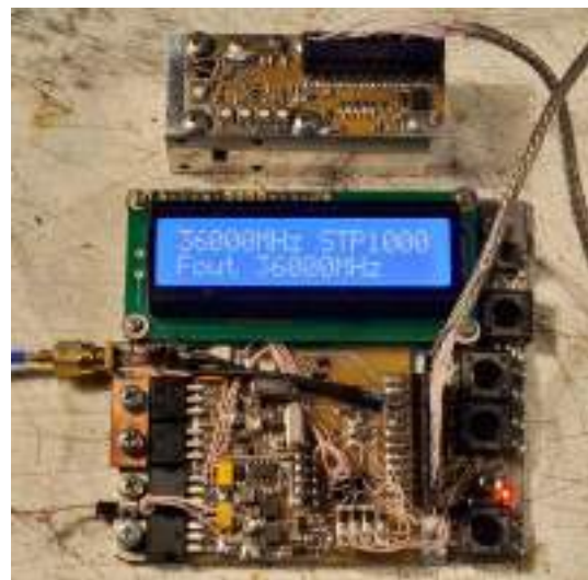
Рис. 5 – Фото гетеродину з блоком перестроювання частоти і індикації
