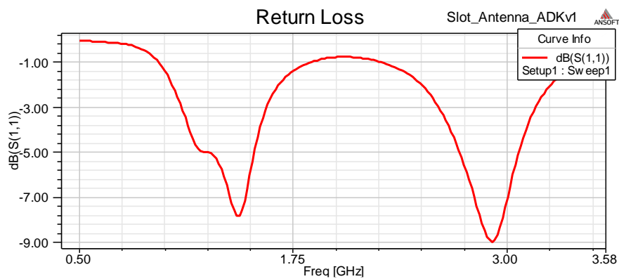
Рисунок 4. Частотна характеристика втрат сигналу однощілинної симетричної антени
