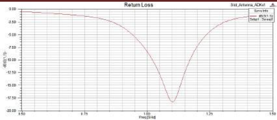
Рисунок 4. Частотна характеристика втрат сигналу однощілинної симетричної антени
